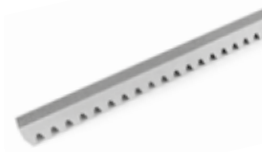
CRIS 600 Crémaillère m6 30x30x1000 mm zinguée, à souder, à accoupler à la couronne M600
